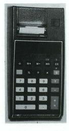
Auch das hat HP gebaut: Dieses Modell wurde Ende Februar 1978 gebaut. Ohne ENTER-Taste, Drucker und Gehäuse sind identisch mit dem zur gleichen Zeit gebauten technischwissen-schaftlichen HP-19C.
